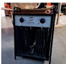
Nagrzewnica elektryczna Skan 20 kW
